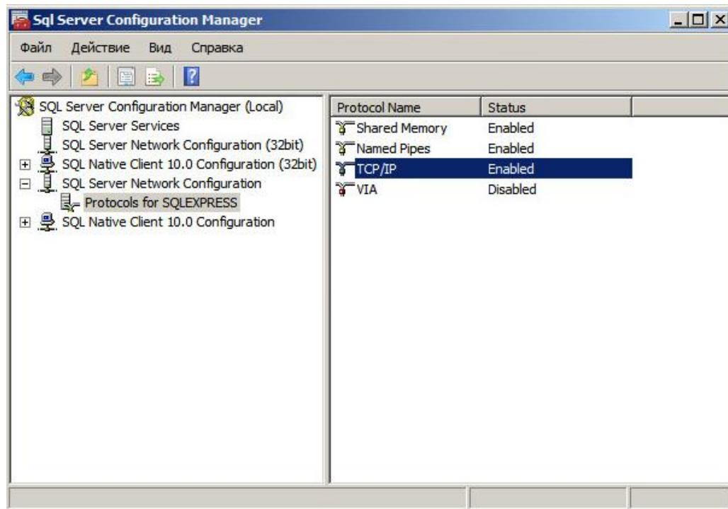
Рисунок 6 – Настройка TCP/IP при конфигурации MS SQL Server 2008 R2 Express Edition
